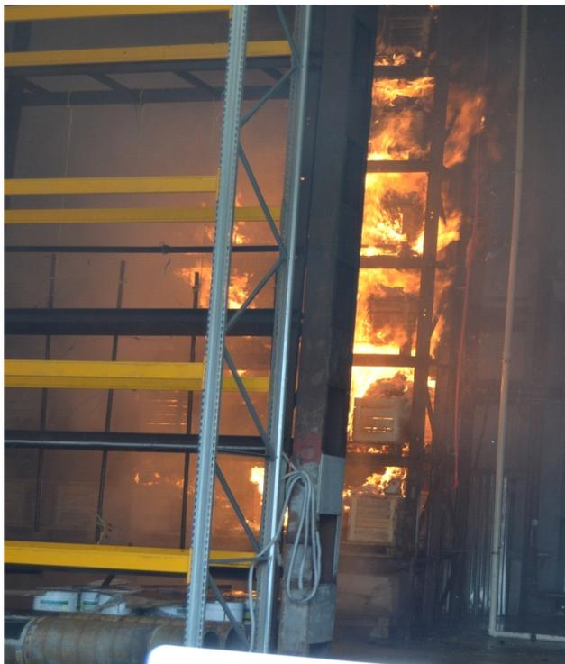
На фото – испытания трубопроводов ПОТОК-FIREPROFF на пожаростойкость в условиях развитого пожара в высокостеллажных складах.
