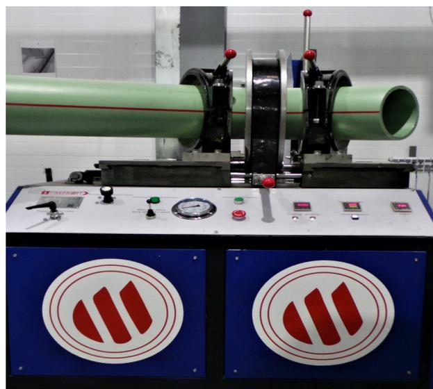
Рисунок В.5 –Нагрев элементов трубы в сварочном аппарате
